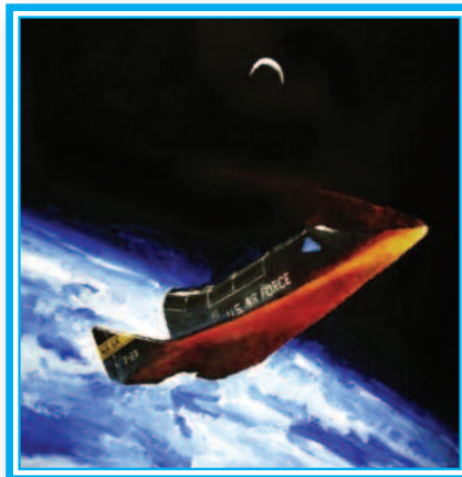
Il velivolo X-20 Dyna-Soar aveva fusoliera portante per il rientro atmosferico planato
