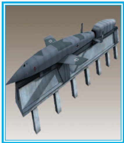
Il Silbervogel, dotato di fusoliera portante, sulla sua rotaia di 3 Km di lunghezza su cui accelerava fino al doppio della velocità del suono prima di inserirsi in una traiettoria suborbitale
