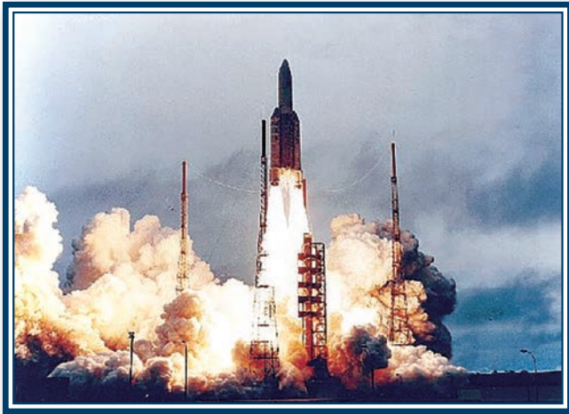
Lancio di Arianne 5: i booster AVIO forniscono il 90% della spinta durante la prima fase di volo
