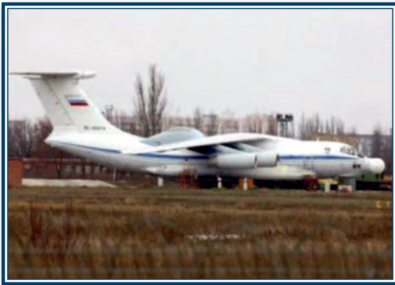
Beriev A-60, si nota la torretta del laser dorsale mentre nel musone è alloggiato un Lidar per lo studio della propagazione atmosferica.
