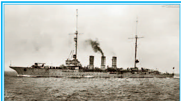
L'incrociatore Ancona con la prua allungata per contenere la catapulta per il lancio di un idrovolante M18AR
