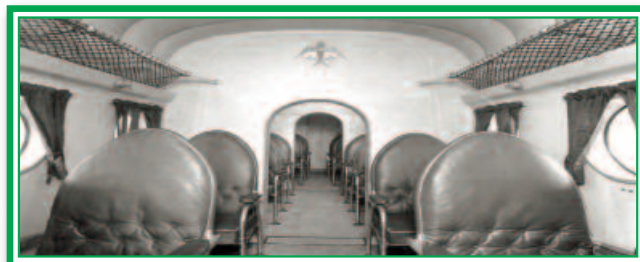
Immagine esterne ed interne del Macchi MC94 . Idrovolante a scafo centrale, monoplano, bimotore, di costruzione lignea, progettato da
