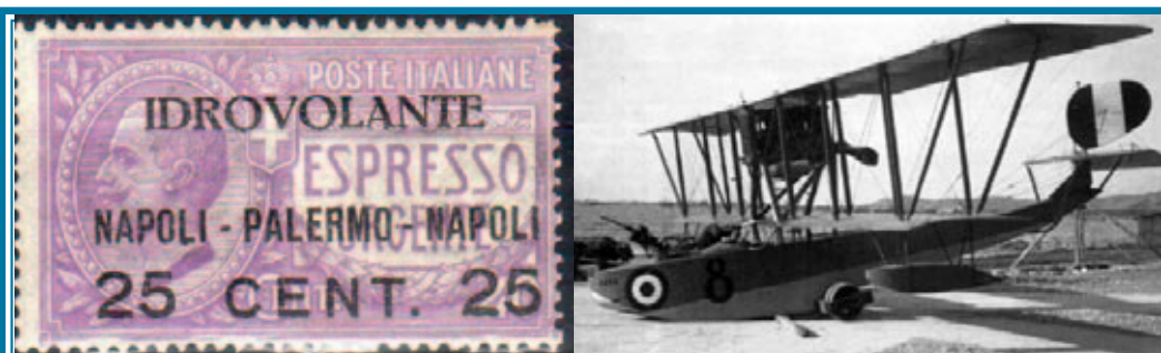
Secondo francobollo di posta aerea emesso e idrovolante FBA (costruito su licenza in Italia in circa 1000 esemplari, fu impiegato per tutto il periodo bellico dalle squadriglie da ricognizione marittima della Regia Marina, equipaggiato con un motore I.F.V4B da 180cv raggiungeva la velocità massima di 140km/h)
