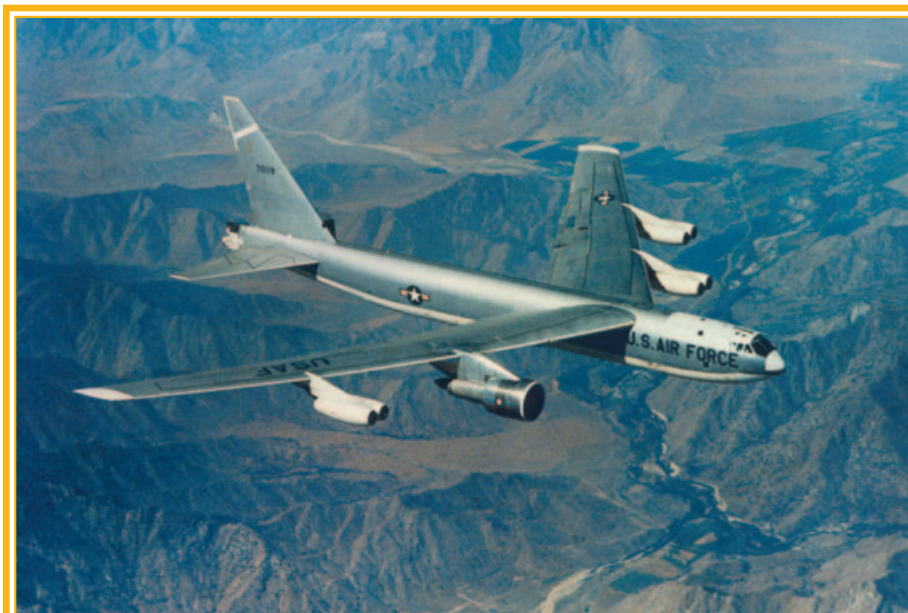
Singolo turbofan TF39-GE-C1 sul pilone interno ala destra su B52E Engine Test Bed
