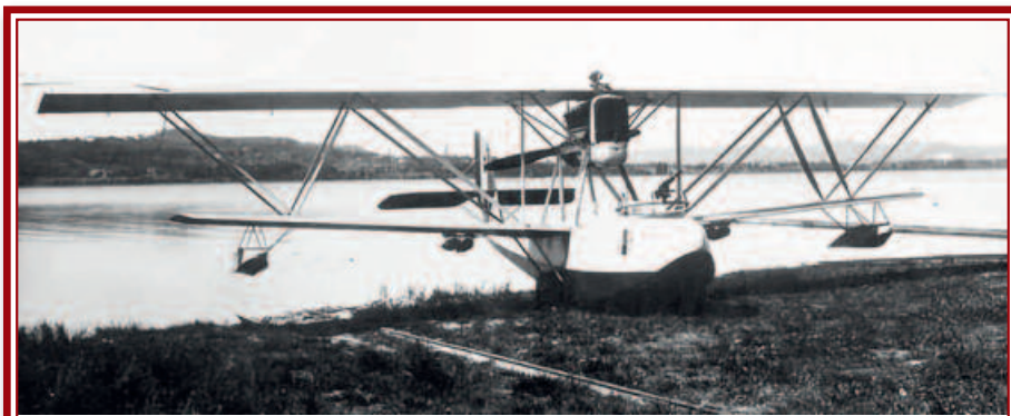
Velivolo M18 con motore I.F. V6 – equipaggiato con mitragliatrice anteriore e 4 bombe da 20Kg appese sotto l'ala
